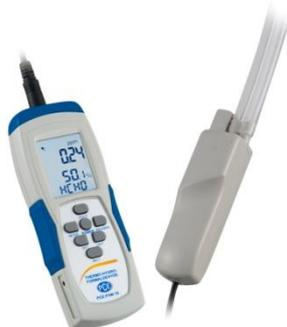
Ausgasende Materialien, wie verleimte Span- oder Faserplatten, Fußböden, Möbel usw. sind nicht selten. Das Reizgas hat einen stechenden Geruch und ist farblos. Die Konzentration von Formaldehyd kann in der Raumluft nachgewiesen und gemessen werden.
