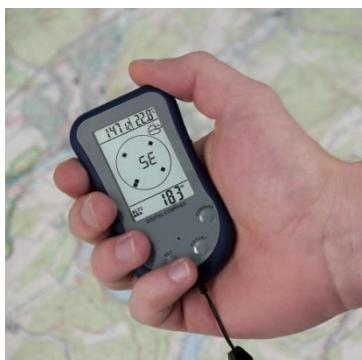
Altimeter messen barometrisch, mit Schall, mit Mikrowellen (Radar) oder mit Laserstählen die Höhe.
