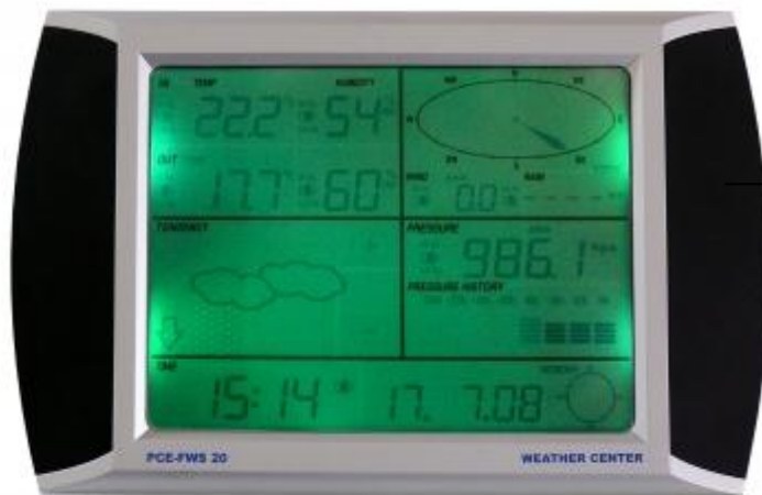
Touchscreen Display der Wetterstation
