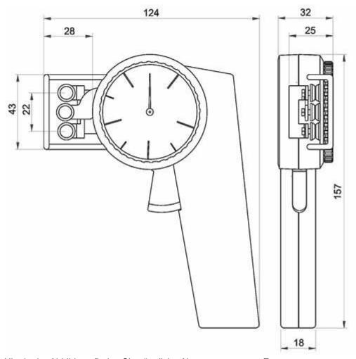
Hier in der Abbildung finden Sie sämtliche Abmessungen vom Zugspannungsmesser.
