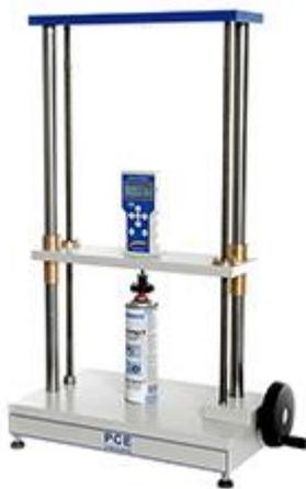
**manueller Zug- und Druckkraftmessstand
