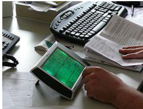
Hier sehen Sie die Bedienung der Wetterstation PCE-FWS 20 über das Touchscreen-Display am Aufstellort
