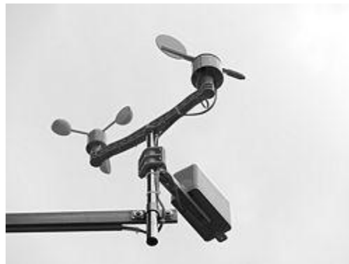
Montage der Sensoren der Wetterstation an einer Metallschiene
