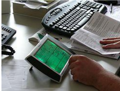
Hier sehen Sie die Bedienung der Wetterstation PCE-FWS 20 über das Touchscreen-Display am Aufstellort
