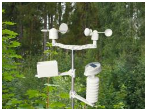
Hier sehen sie den sich im Lieferumfang der Wetterstation befindlichen Wettermast mit Sensoren
