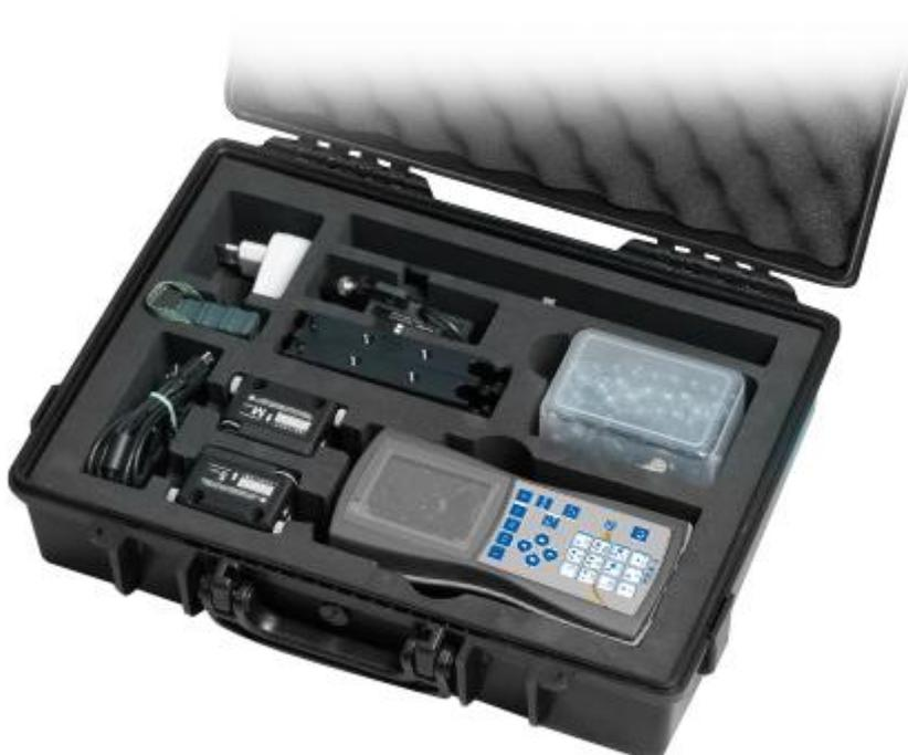
1 x Wellenausrichtsystem PCE-TU 3, 2 x Messsonden, 2 x Montage-Set für die Messsonden,
