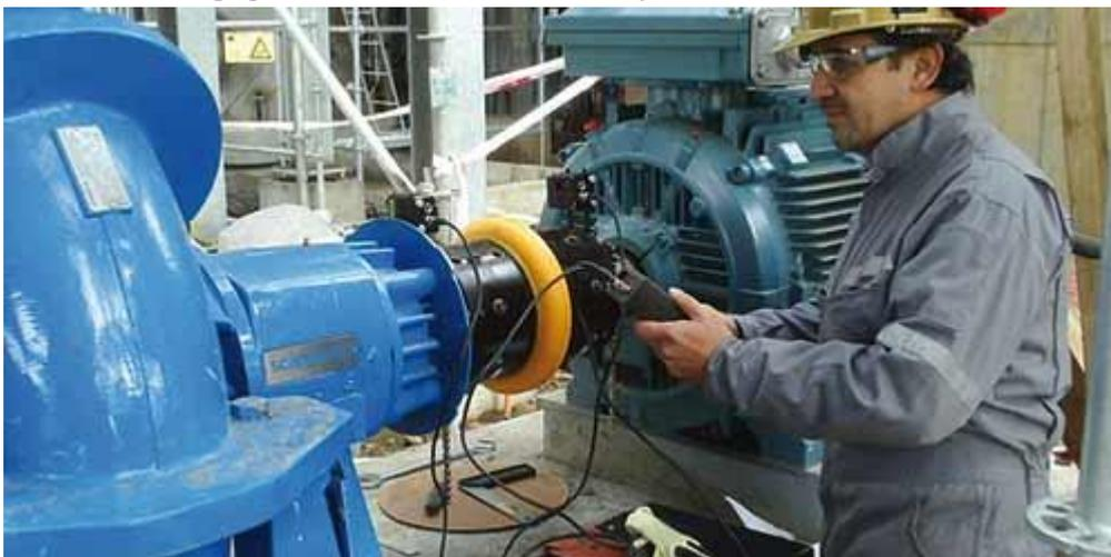
Hier sehen Sie das Wellenausrichtsystem PCE-TU 3 bei der Schwingungsmessung an einer Maschine
