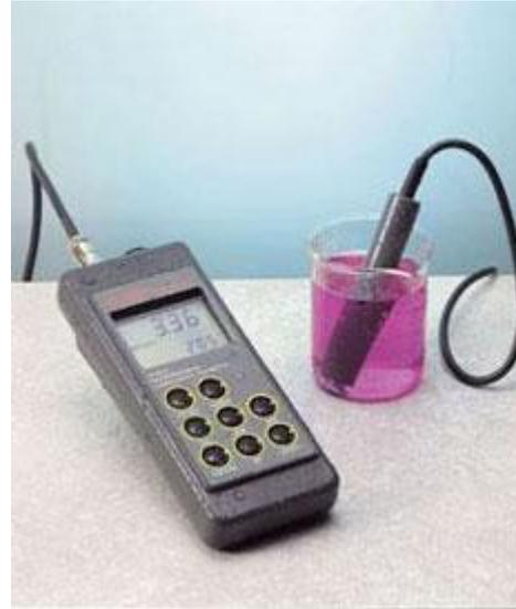
Mit dem wasserdichten Leitwertmessgerät lassen sich schnell Temperatur, Leitwert, Salzgehalt und Natrium-Chlorid in Flüssigkeiten messen. Optimal eignet sich das Messgerät auch für das Labor.
