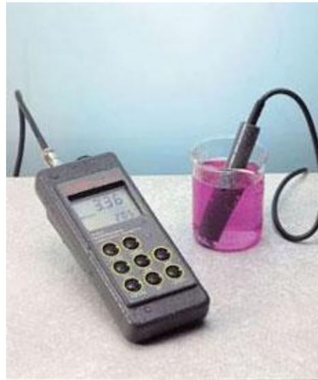
Mit dem wasserdichten Leitfähigkeitsmessgerät HI-9835 lassen sich schnell Temperatur, Leitfähigkeit, Salzgehalt und Natrium-Chlorid in Flüssigkeiten messen. Optimal eignet sich das Messgerät auch für den Einsatz in Laboren.
