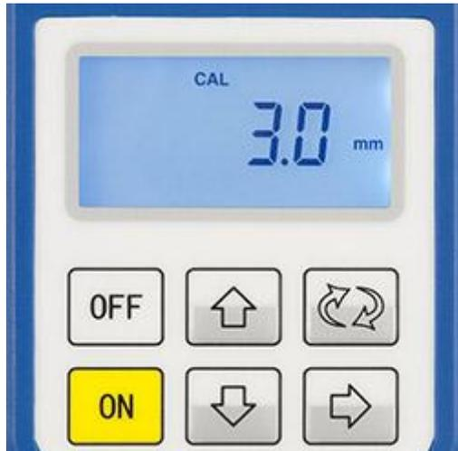
Das Wanddicken-Prüfgerät PCE-TG110 der Einjustage an der integrierten Kalibrierplatte
