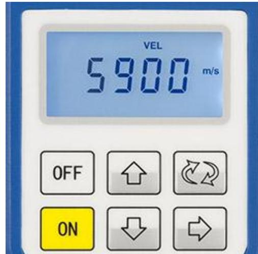
Das Wanddicken-Prüfgerät bei der Einstellung der Ultraschallgeschwindigkeit
