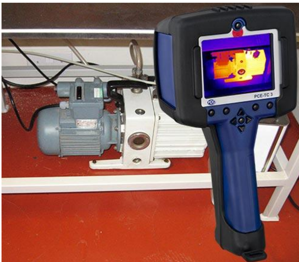
Beispiel der Thermographie einer Motor - Getriebeeinheit mit unserer PCE-TC 3
