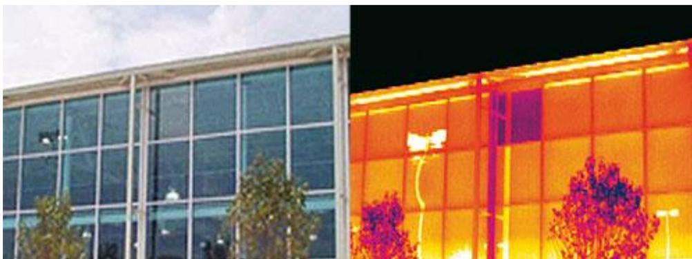
Die Infrarotinspektion entdeckt ein falsch eingebautes Glaselement. Die Beschichtung ist innen statt außen am Fenster angebracht.
