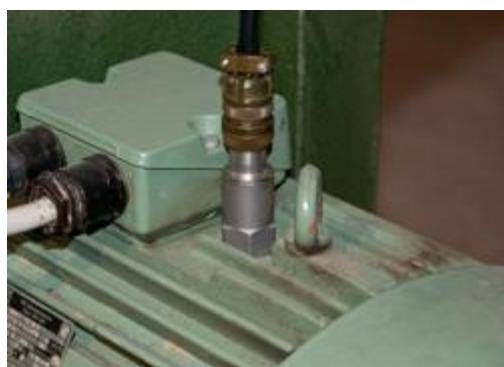
Hier sehen Sie den Vibrationsschalter im Einsatz auf einem Motor
