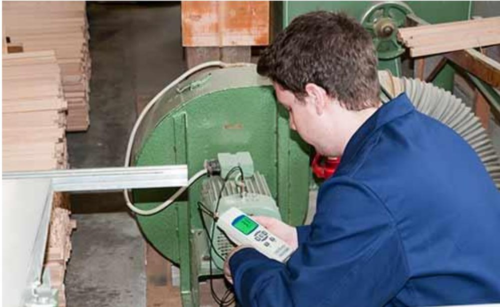
Hier sehen Sie den Vibrationsmesser PCE-VT 2800 bei der Überprüfung eines Motors
