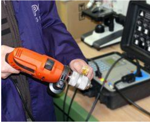
Das VDE-Testgerät Safetytest 1N im Einsatz bei der Prüfung einer Bohrmaschine
