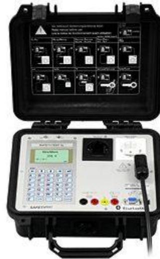
Der in einem robusten Koffer untergebrachte VDE-Prüfer Safetytest 1L
