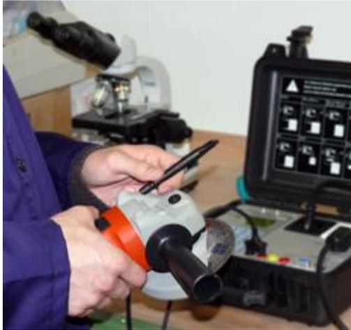
Der VDE-Prüfer bei der Wiederholungsprüfung von elektrischen Betriebsmitteln
