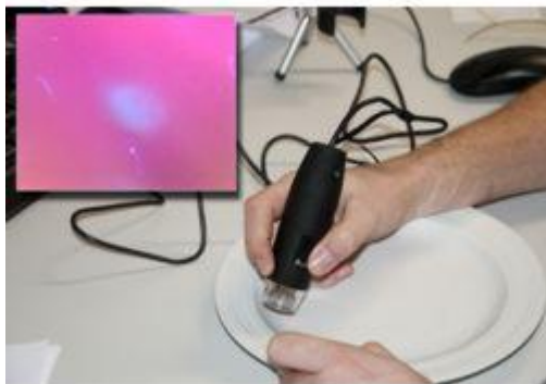
Kontrolle eines Tellers auf Stärkereste nach dem Spülmaschinendurchlauf mit dem UV-USB Mikroskop PCE-MM 200UV
