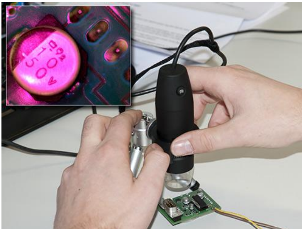
Das UV-USB-Mikroskop PCE-MM 200UV bei der Betrachtung einer Platine.
