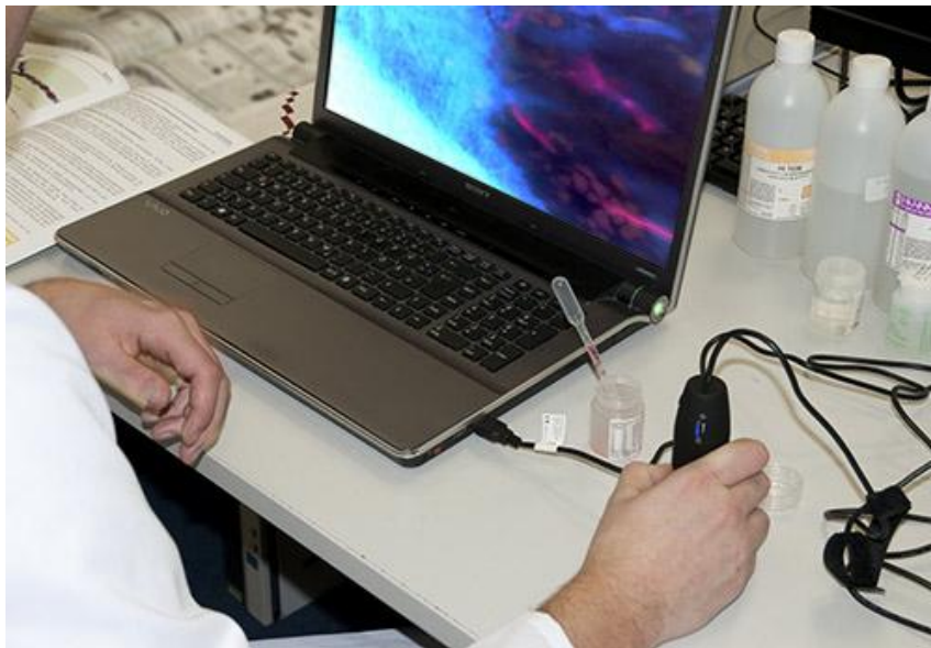
Das UV-USB-Mikroskop PCE-MM 200UV im Laboreinsatz
