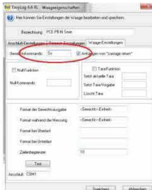
Anbindung der USB Tischwaage an die GePard / GLS, EasyLog / DHL Versendersoftware. Der Abfragebefehl für die USB Tischwaage lautet **Sx**.
