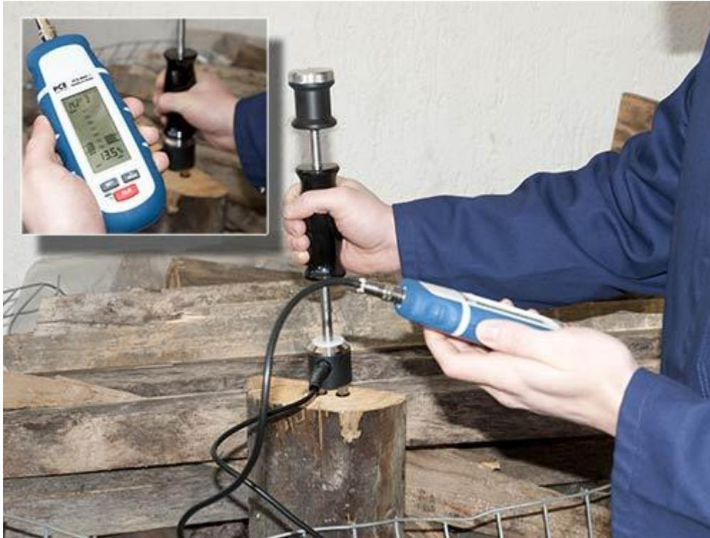
Hier misst der Universalfeuchtemesser mit seiner externen Rammelektrode
