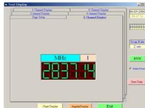
Die optionale Software vom Universal - Frequenzzähler erlaubt (in Verbindung mit dem RS-232-Datenkabel) den Messwerttransfer vom Frequenzzähler zu einem PC. Hierbei ist die Übertragungsrate 1 Wert/ 2 s.
