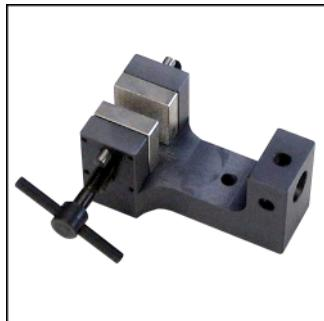
Schraubspannkopf zum Einspannen von Papier, Folien, Stoff etc.
