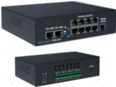
Dieses Gerät wird zur Überwachung und Automation z.B. in von der Hauptstation entfernten Räumen verwendet. Eingänge für 8 Analogsensoren, 10 Digitalsensoren oder 1 Näherungskartenleser / iButton Lesekopf. Zusätzlich beherbergt das Modul vier 3-Punkt-Relais mit maximaler Schaltleistung von 10 A - 250V AC / 30 Volt DC.
