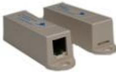
Dieser Magnet-Sensor kontrolliert den Zustand von Türen und Fenstern an denen er installiert ist. Dadurch kann das Überwachungssystem z.B. im Zusammenhang mit einer Hausautomation auf den Zustand des Sensors reagieren. Abmessungen: 2 Geräte 60x18x18 mm, Gewicht: 80g. Inklusive 2 m Anschlusskabel und Befestigungsmaterial.
