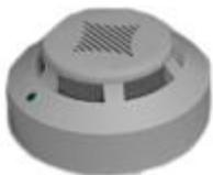
Der Rauchmelder reagiert auf die Entstehung von Rauch. Die Rauchmelder können wahlweise in Reihe geschaltet werden, um nur einen Port des Überwachungssystems zu belegen. Gewicht: 220g, Abmessungen: Ø100x45 mm. Inkl. 2m Anschlusskabel und Befestigungsmaterial.
