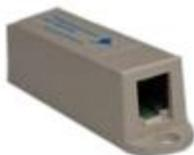
Luftfeuchtesensor 20 - 95% relative Feuchte. Genauigkeit: 5%, Abmessungen: 60x18x18 mm, Gewicht: 50g Lieferumfang: Sensor, 2m Anschlusskabel, Befestigungsschraube, doppelseitiger Klebestreifen .
