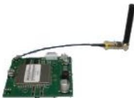
Das GSM Modul versetzt das Überwachungssystem in die Lage auch beim fehlen einer Internetverbindung per SMS Benachrichtigungen zu versenden. Es wird in der Haupteinheit des Überwachungssystems verbaut.
