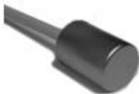
Außentempersensor zu dem Überwachungssystem mit einem Temperaturbereich von -40°C bis +100°C. 15m Anschlusskabel sind fest am Sensor verbaut. Abmessungen: Ø12x28 mm, Gewicht 450 g.
