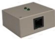
Ein kompaktes Gerät welches den Luftfluss überwacht. Es misst den Luftfluss an 4 Punkten. Bei Mangel von Luftfluss oder Wind an einem Messpunkt geht der Sensor auf "Warnung"; bei Mangel der Signale bei mehr als zwei Punkten auf "Alarm". So können beispielsweise Lüfter durch das Sensor System überwacht werden. Ansprechzeit 1 Sekunde. Wiederanlaufzeit 4 Sekunden. Inkl. Befestigungsmaterial. Abmessungen: 40x40x20mm, Gewicht 20g
