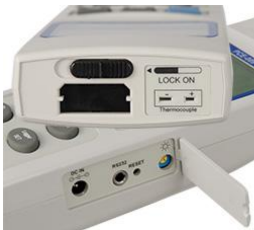
Das Thermoanemometer bietet K-Typ Fühler, RS-232- und Netzteil- Anschluss
