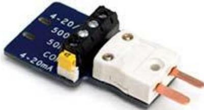
Beim PP624 handelt es sich um ein optionales Klemmbrett für den Temperatur-Datenlogger Pico TC-08. Die Schraubklemmen machen es möglich, Drähte ohne zu Löten am Temperatur-Datenlogger anzubringen und somit Spannungen bis zu 5 V oder 4-20 mA Stromschleife zu messen.
