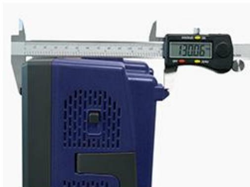
Mit 13 cm Tiefe des Gehäuses ist das Speicheroszilloskop PCE-UT 2042C für den mobilen Einsatz geeignet.
