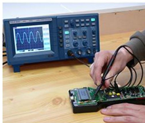
Hier sehen Sie das digitale Speicheroszilloskop PCE-UT 2042C im Einsatz bei der Schwingungsmessung eines Quarzes.
