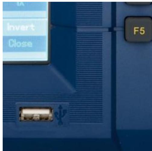
Anschluss für USB-Sticks zum speichern von Signalen und Einstellungen vom Speicheroszilloskop.
