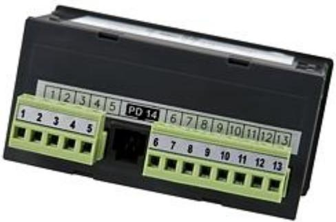
Die Spannungsanzeige wird über die an der Rückseite angebrachten Schraubklemmen elektrisch angeschlossen. Eine Übersicht der Anschlüsse ist auf dem Gehäuse untergebracht und ermöglicht so einen schnellen und sicheren Einbau vor Ort. Die Programmierschnittstelle der Spannungsanzeige (PD14) ist ebenfalls hier untergebracht. Sie ist als Western-Buchse ausgeführt. Der Programmieradapter setzt den Datenstrom auf eine USB-Schnittstelle um.
