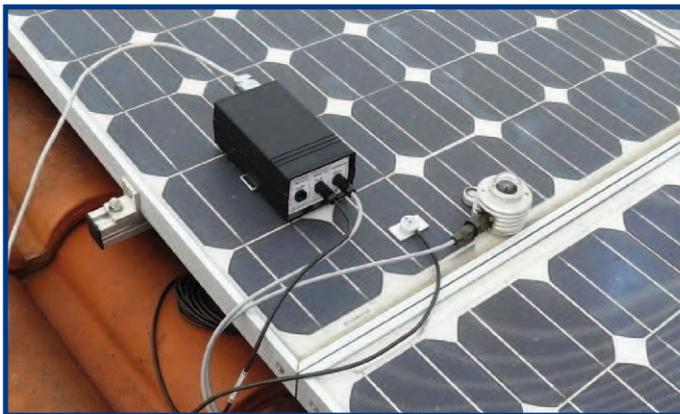
Für Messungen an größeren Anlagen verfügt der **GREENTEST**-Prüfer über eine Fernmesseinheit, die die Messwerte lokal z. B. auf dem Dach aufnimmt und die Messdaten über bis zu 100 m Entfernung drahtlos per Bluetooth oder über ein 15 m langes Datenkabel mit einem 9-Pin RS232-Steckverbinder an das Prüfgerät in Echtzeit übermittelt.
