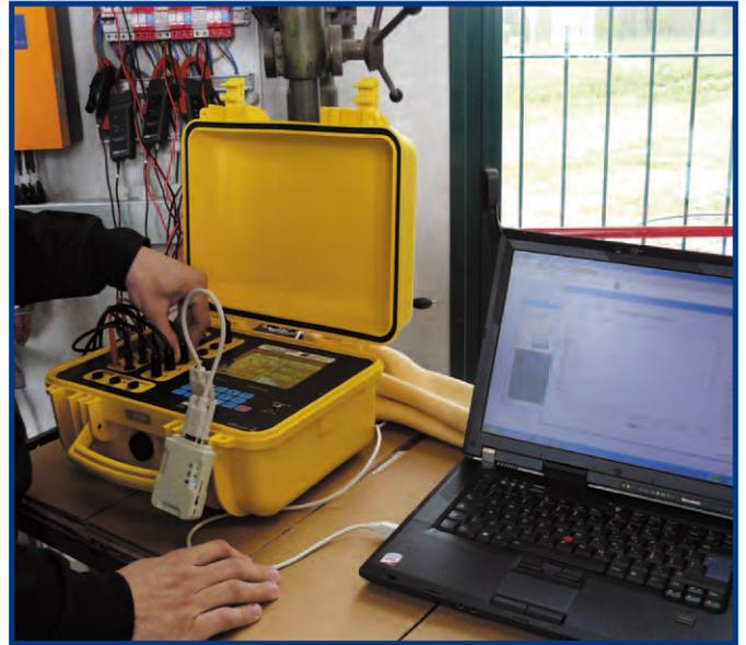
**Alle Messungen werden gleichzeitig vorgenommen:** Spannungen, Ströme, Berechnung der Leistung, Temperaturmessung, usw... Je nach Auslegung der Anlage werden 1 oder 3 Strommesszangen benötigt. Deswegen gibt es zwei vorkonfigurierte Versionen des GREENTEST-Prüfers FTV-100:
