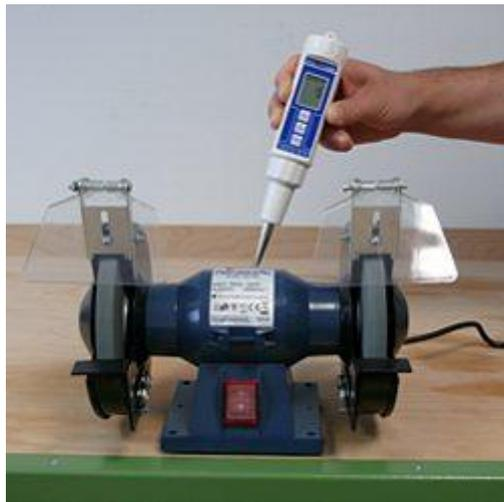
Hier sehen Sie den Schwingungstester bei einer Überprüfung an einem Schleifbock.
