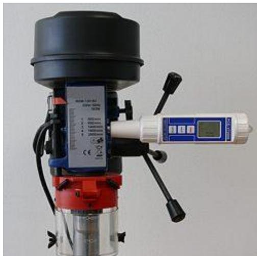
Hier sehen Sie den Schwingungstester bei einer Überprüfung an einer Standbohrmaschine.
