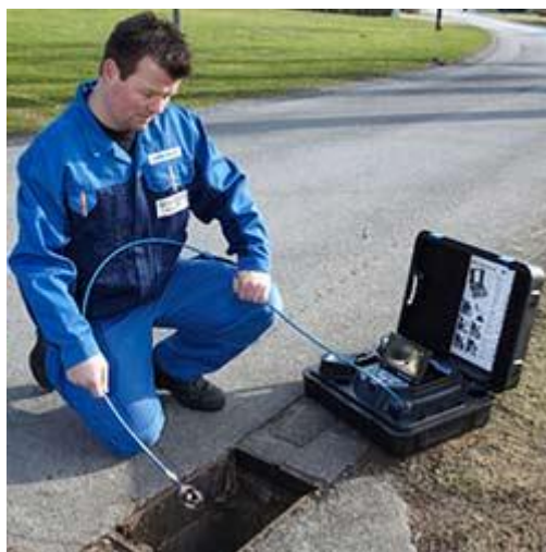
Hier sehen Sie die Anwendung vom Endoskop VIS 300 / 350 an einem Kanalsystem
