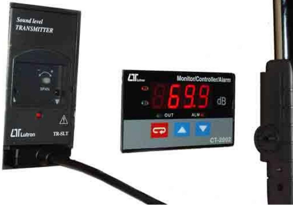
Hier sehen Sie den Schall Messumformer - SLT in Betrieb. Die Schallwarnanlage ist für die Dauermessung vorgesehen und wird einsatzfähig geliefert. Die Verkabelung ist das Einzige, welches der Kunde selbst vornehmen muss. Somit ist das Schallüberwachungsgerät schnell zur Messung einsatzfähig.
