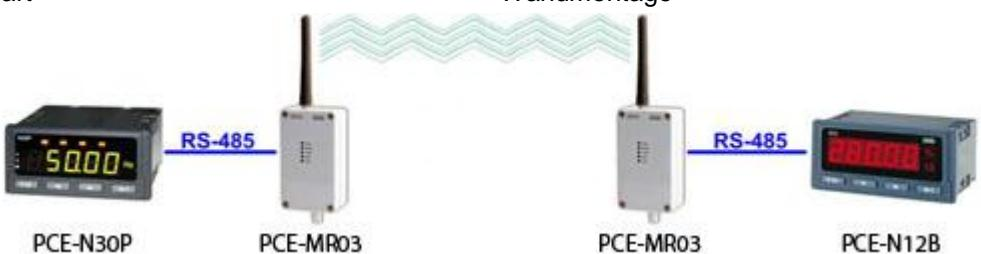
Die gemessenen Netzparameter vom [PCE-N30P Leistungsmesser](#) werden mit dem RS485-Funksystem PCE-MR03 an die [Slaveanzeige PCE-N12B](#) drahtlos übertragen.
