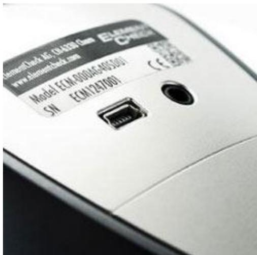
Der USB-Anschluss vom RFA-Analysator zum übertragen der Daten auf einen PC / Laptop.
