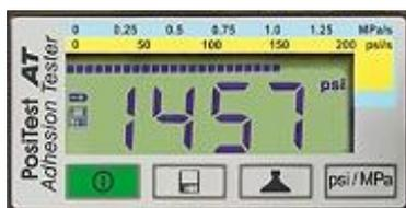
Das digitale Display vom Haftfestigkeitsprüfgerät gibt Ihnen neben der reinen Darstellung der Meßwerte (in Pa oder psi) weitere Informationen über: Zustand der Batterien, Messmodus in dem Sie sich befinden, Speichermodus (an / aus), Zugeschwindigkeit (wie viel Druck/ Zeit geben Sie auf).
