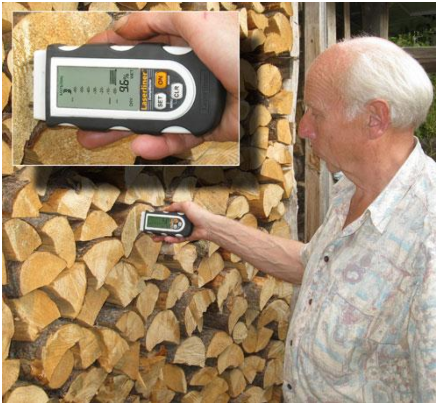
Aufgrund der einstellbaren Kennlinien ist eine genaue, materialspezifische Messung, sowohl in Kiefernholz
