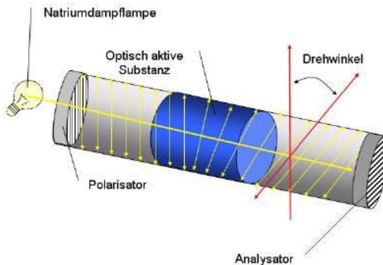
Mithilfe von zwei aufeinander aufgebauter Polarisatoren - der hintere davon Analysator genannt - lassen sich folgende Effekte beobachten:
