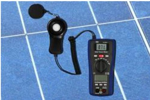
Der Photovoltaik Messer bei einer Kontrollmessung
