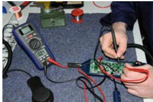
Das Multimeter des Photovoltaik Messer bei einer Fehleranalyse
