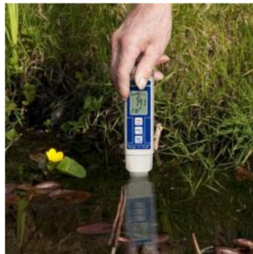
Mit dem wasserdichten pH-Tester PCE-PH 22 kann man schnell den pH-Wert messen. Auch die aktuelle Temperatur vom Medium wird im Display angezeigt.
