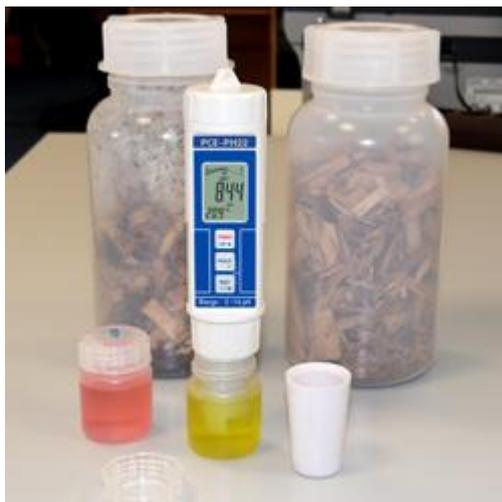
Dieses Bild zeigt den pH-Tester bei der Kalibrierung. Die Zwei-Punkt Kalibrierung wird mit dem Kalibrierkit pH-4 und pH-7 durchgeführt (im Lieferumfang enthalten).
