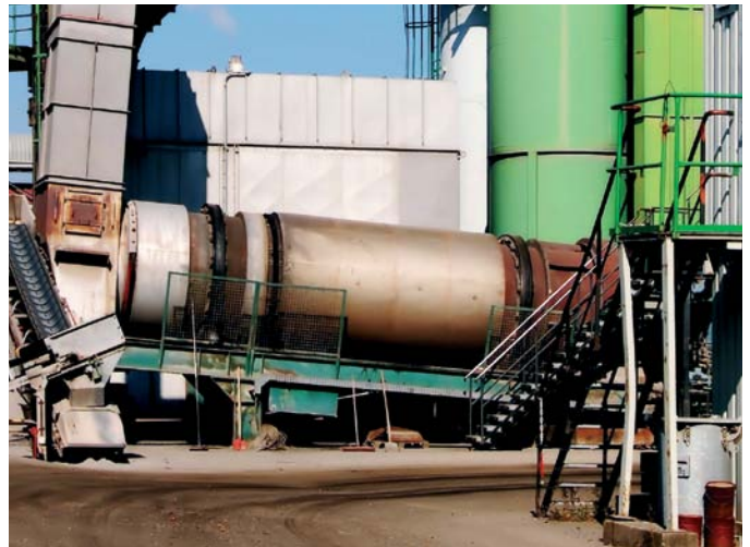
Anwendungsbeispiel: Drehrohren in der Chemieindustrie
