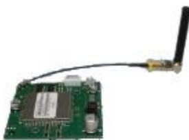
Das GSM Modul versetzt das Monitoringsystem in die Lage auch beim Fehlen einer Internet-Verbindung per SMS Benachrichtigungen zu versenden. Es wird in der Haupteinheit des Monitoringsystems verbaut.
