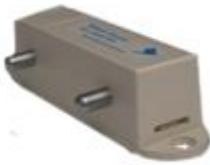
Die Metallstangen dieses Sensors sind Wasserdetektoren und der Sensor reagiert auf den direkten Kontakt der Metallstangen mit Wasser um durch das Monitoringsystems zum Beispiel einen Alarm auszulösen. Abmessungen: 60x18x18 mm, Gewicht: 60g. Inklusive 2 m Anschlusskabel und Befestigungsmaterial.
