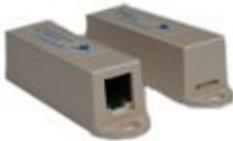
Dieser Magnet-Sensor kontrolliert den Zustand von Türen und Fenstern an denen er installiert ist. Dadurch kann das Monitoringsystem z.B. im Zusammenhang mit einer Hausautomation auf den Zustand des Sensors reagieren. Abmessungen: 2 Geräte 60x18x18 mm, Gewicht: 80g. Inklusive 2 m Anschlusskabel und Befestigungsmaterial.
