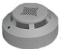
Der Rauchmelder reagiert auf die Entstehung von Rauch. Die Rauchmelder können wahlweise in Reihe geschaltet werden, um nur einen Port des Monitoringsystems zu belegen. Gewicht: 220g, Abmessungen: Ø100x45 mm. Inkl. 2m Anschlusskabel und Befestigungsmaterial.
