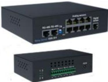
Dieses Gerät wird zum Monitoring und Automation z.B. in von der Hauptstation entfernten Räumen verwendet. Eingänge für 8 Analogsensoren, 10 Digitalsensoren oder 1 Näherungskartenleser / iButton Lesekopf. Zusätzlich beherbergt das Modul vier 3-Punkt-Relais mit maximaler Schaltleistung von 10 A - 250V AC / 30 Volt DC.
