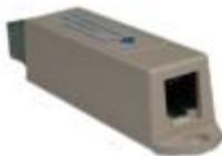
Dieser Sensor verfügt über ein Detektionskabel und schlägt bei Kontakt des Kabels mit Wasser an um dem Monitoringsystem auch Zugang zu schwierigen Orten zu ermöglichen. Ansprechzeit: 7–12 Sekunden. Kabellänge: 1–100m. Abmessungen: 60x18x18 mm, Gewicht: 20g. Inklusive 2 m Anschlusskabel und Befestigungsmaterial.
