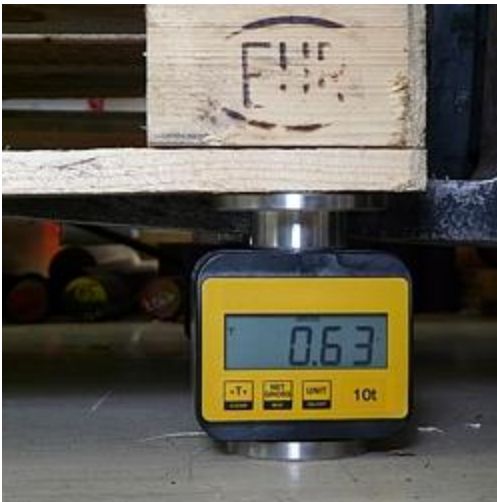
Hier sehen Sie eine Lastecke MLE-F unter einer Palette
