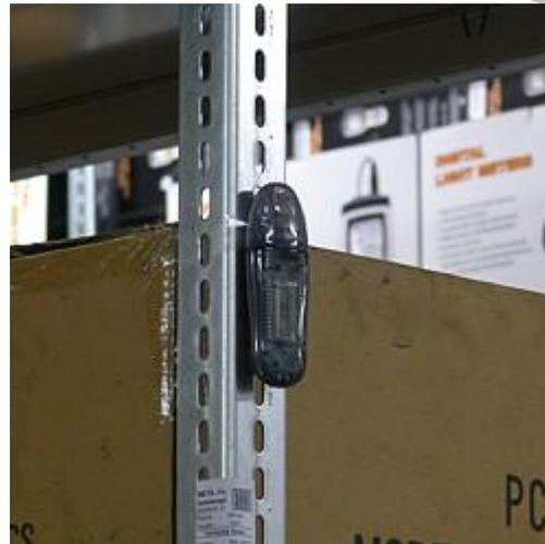
Hier sehen Sie den Minidatenlogger / Minillogger bei einer Temperaturüberwachung im Lager
