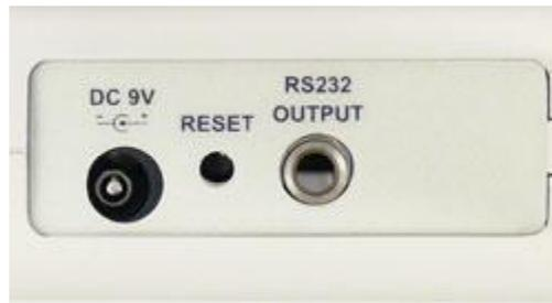
Hier sehen Sie die Anschlüsse für die optional erhältliche Software und das Netzteil
