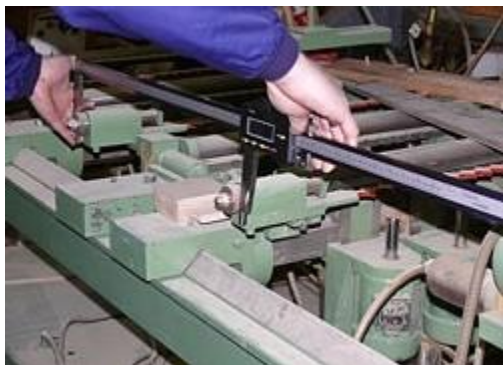
Der Messschieber PCE-DCP 1000 bei Einstellarbeiten an einer Holzmaschine
