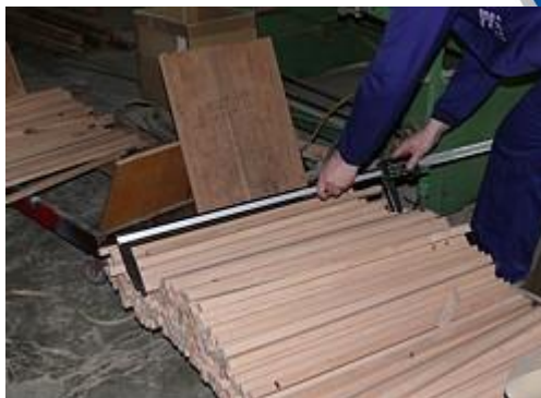
Der Messschieber PCE-DCP 1000 bei einer Zwischenkontrolle von Zeitungshaltern
