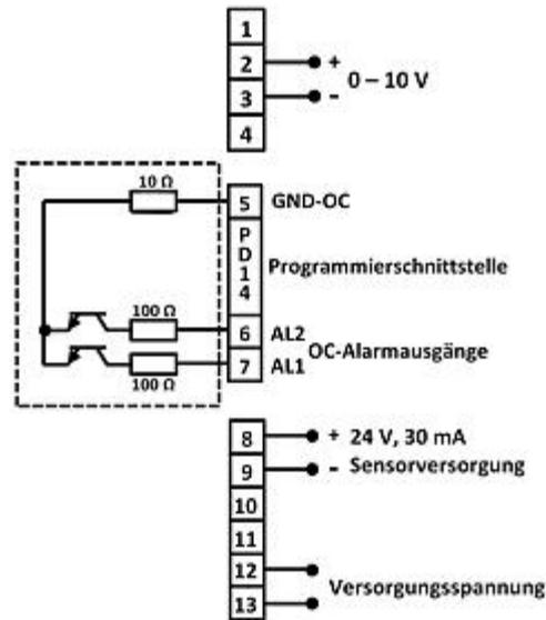
Der elektrische Anschluss von dem Messinstrument erfolgt über Schraubklemmen. Auf dem Gehäuse ist ein Anschlussplan (ähnlich der Abbildung rechts) abgebildet. Somit ist vor Ort ein schneller und sicherer Einbau gewährleistet. Weiterhin befindet sich auf der Rückseite des Gehäuses auch die Programmier-Schnittstelle (PD14).
