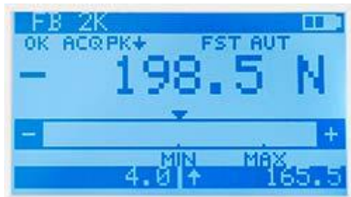
Messgerät für Zugkraft / Druckkraft PCE-FB Serie: Informationen wie Batteriezustand, Messgeschwindigkeit, Kraft, Min und Max auf einen Blick
