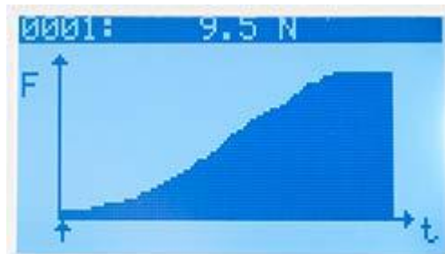
Messgerät für Zugkraft / Druckkraft PCE-FB Serie: Auswertung bzw. des Speichers in Diagrammform wobei einzelne Messpunkte abgefragt werden können.
