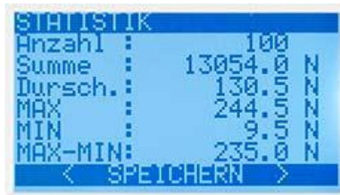
8 Speicherplätze mit individueller Beschriftung und jeweils 800 Messungen im Messgerät für Zugkraft / Druckkraft PCE-FB Serie
