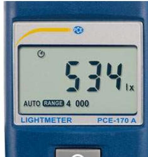
Das Helligkeitsmessgerät PCE-170A ist mit einer großen, 5-stelligen LCD-Anzeige ausgestattet.
