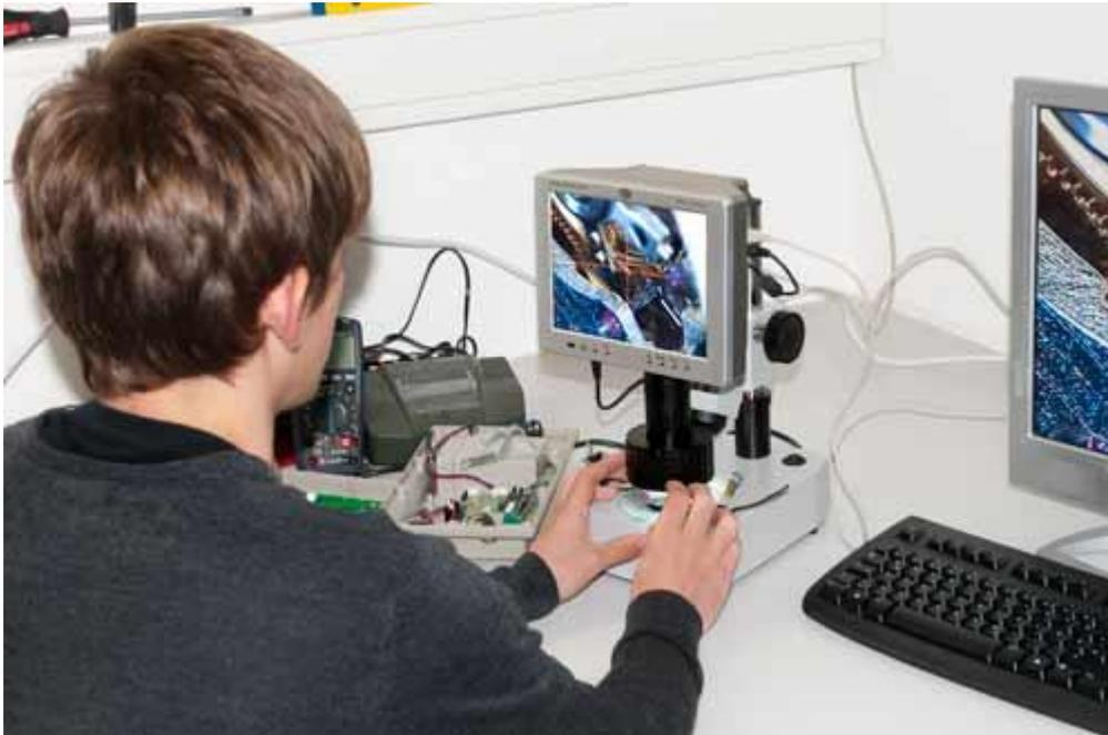
Hier sehen sie das mechanische 3D-Mikroskop bei der Untersuchung eines Laufwerks über das Display
