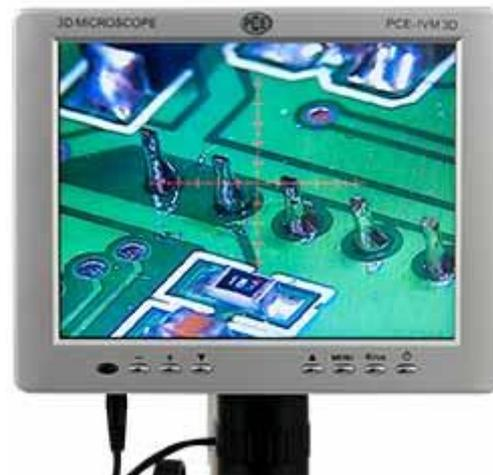
mechanisches 3D-Mikroskop PCE-IVM 3D mit großem 8" LC Display
