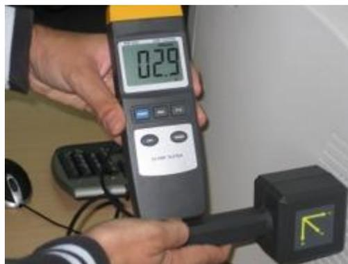
In den obigen Bildern sehen Sie den Strahlungstest von unserem Magnetfeldmessgerät PCE-G28 an einem Monitor und an einem Mittelspannungsturm. Durch die Drei-Achsen-Sonde kann das Magnetfeldmessgerät die drei Raum- oder Vektoren-Komponenten vom magnetischen Feld erkennen.
