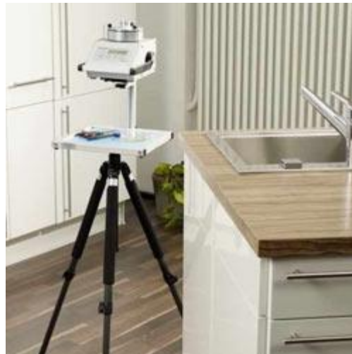
Luftkeimsammler MBASS30 im Einsatz bei einer Probenahme.
