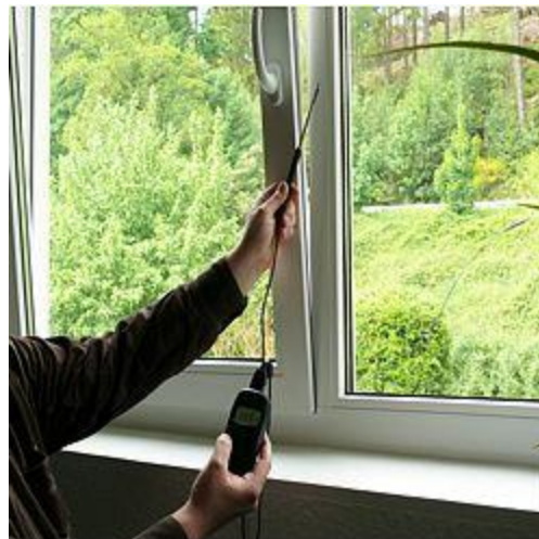
Das Luftdichtheitsmessgerät KM-A004 bei einer Zugluftmessung an einem Fenster
