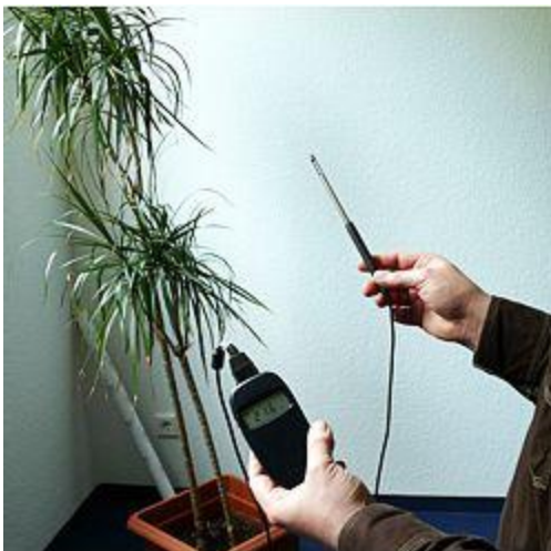
Das Luftdichtheitsmessgerät KM-A004 bei der Messung der Raumtemperatur
